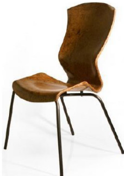
شكل " 32 " مقعد Coir Fiber Chair اعتمد تصميم المقعد على استخدام لفائف جوز الهند والراتنجات المصنعة من السليلوز لإعطاء اللفائف الصلابة والمتانة ، وبتقنيات الصب تم تشكيل المقعد على عدة منحنيات تتكيف وتتفاعل مع وضعية الجلوس
