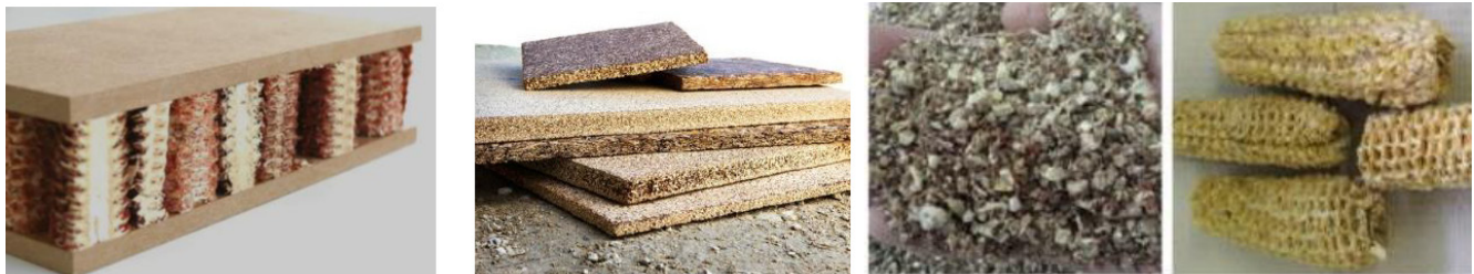
شكل " 18 " الاستفادة من المخلفات الزراعية للذرة الشامية في صناعة الألواح المضغوطة وقواطع الفراغات الداخلية
