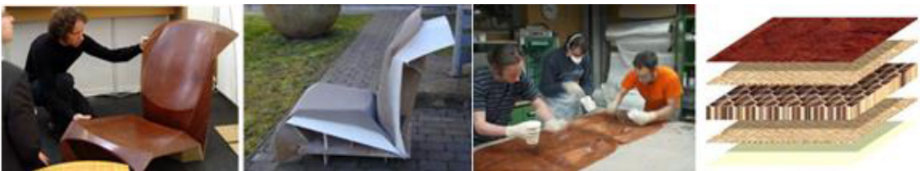
شكل " 26 " مقعد AufjedenFalz – من قطعة واحدة مكونة من خمس طبقات رقيقة بالترتيب من اعلى ( أقمشة BarkTex – طبقة من ألياف نبات القنب المضغوطة – طبقة من الكرتون المقوى – طبقة ثانية من ألياف نبات القنب – طبقة رقيقة من القطن المكبوس ) ، المقعد يعكس مزج الخامات الطبيعية لإضافة مميزات للخامة كالمتانة والصلابة وقابلية التحمل
