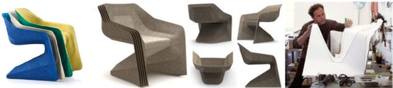
شكل " 24 " مقعد Hemp Chair للمصمم Werner Aisslinger – المقعد مصنوع من ألياف القنب المشكلة بالقالب ، حيث يحقن خليط الألياف مع راتنجيات الاكرليك في قالب مسبق التجهيز تحت درجة حرارة عالية – يتميز المقعد بانسيابية خطوطه التصميمية وخفة الوزن وسهولة التخزين خامته الطبيعية
