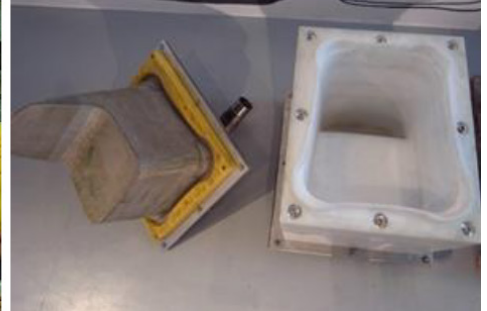
شكل " 8 " مقعد Parupu للمصمم claesson koiviisto –خامة المقعد DuraPulp وهي عبارة عن لب الورق المستخلص من ألياف السليلوز مع البلاستيك القابل لإعادة التدوير ، اعتمد تصنيع المقعد على الاساليب التكنولوجية الحديثة بدمج الخامات تحت درجة حرارة تصل إلى 167 درجة باستخدام القوالب لينتج مقعد بسبك 2مم يتسم بالمتانة العالية
