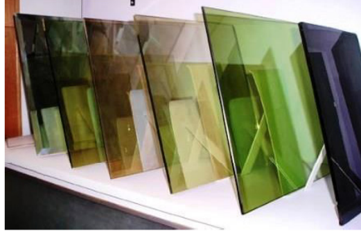
صورة رقم (4) وشكل رقم (3) يوضح الزجاج الماص للحرارة Heat Absorbing Glass وكيفية عمله في الغلاف الخارجي
