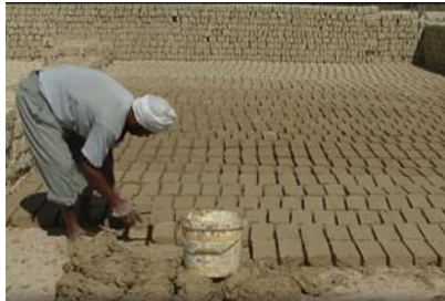
صورة (١٣ و١٤ و١٥) خلط الطمي بالقش (حشا الارض اى الزرع rammed earth او - Cop لعمل مونة الملاط الطيني واستخدام الطفلة الاسوانى فى عمل الطوب الطفى اللين المنتظم المستوى الواجه.
