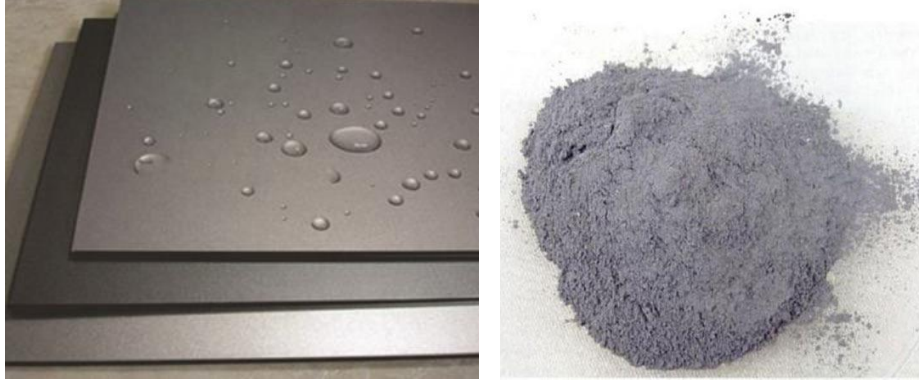
شكل ( ١١ ) يوضح بودرة النانوألومنيوم وقدرتها على التنظيف الذاتى
