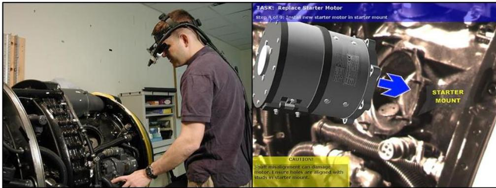
شكل رقم (١٠) صورة توضيحية لإستخدام الواقع المعزز فى عمليات الصيانة
