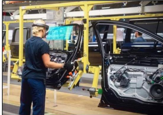
شكل رقم (٩) صورة توضيحية لإستخدام الواقع المعزز فى تجميع مكونات باب السيارة
