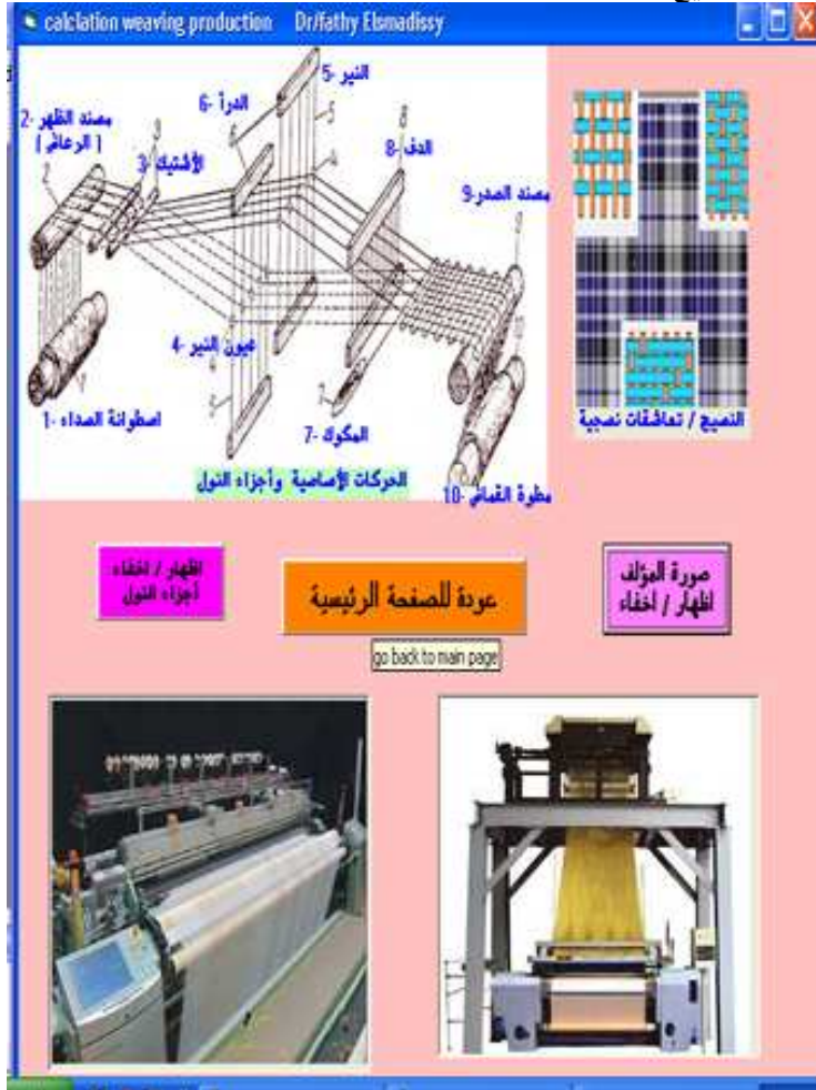
شكل رقم (٥) يوضح نسيج + تعاشقات نسجية – الحركات الأساسية وأجزاء النول- ماكينات نسيج دوبي وجاكارد
