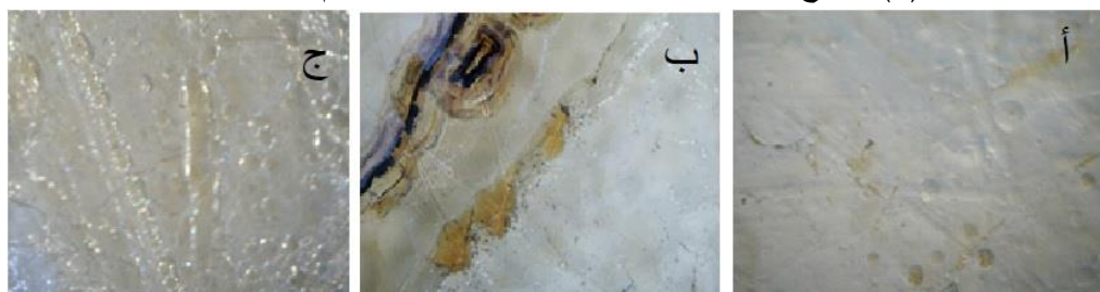
لوحة (٩) توضح (أ) الفقاعات الهوائية بزجاج الأثر، (ب، ج) شكل التآكل بالزجاج باستخدام الميكروسكوب الرقمي .
