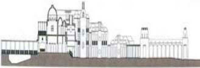
شكل ( ٢٣ ) يوضح مقطع طولي للمسقط العلوي يوضح في أقصى اليسار المسبح المكشوف ، و يمينه مبنى الخدمات ، و في أقصى اليمين واجهة الممر المغطى
