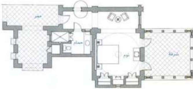
شكل ( ٢٩ ) يوضح مسقط أفقي لإحدى الغرف ذات الجدران سم ٢٥ والشرفة الخارجية المسقوفة http://onkoshdor.blogspot.com
