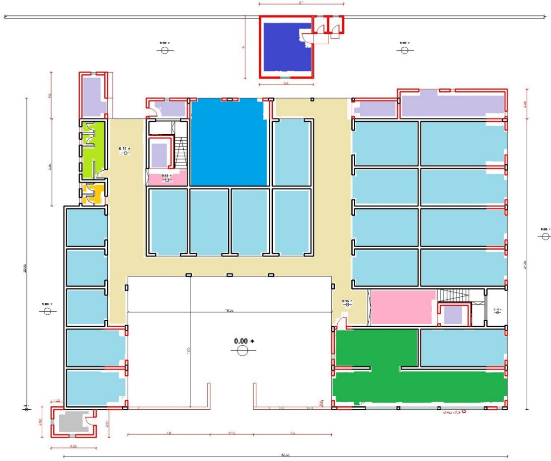
شكل (٢٨) : المسقط الأفقي للدور الأرضي لمبنى المركز الحرفي للورش بعد التغيير وبناء حوائط ومباني مخالفة وعشوائية
