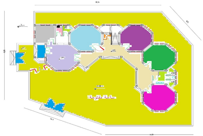
شكل (١١) : المسقط الأفقى للدور الأرضى بمبنى دار الحضانة بعد تغييره إلى مركز التضامن الاجتماعى وتركيب حديد كريتال على الشبابيك وعلى باب قاعة تعليم الكمبيوتر
