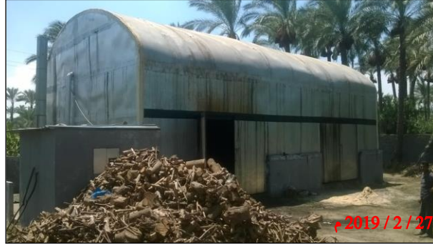
صورة (4) صوبة حرارية لإنتاج الفحم النباتي بقرية ميت أبو الحسين
