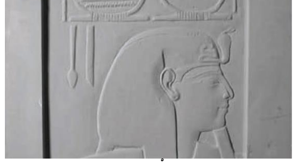
شكل رقم (6): عمل قالب سليكون للوحة التي تم حفرها براوتر CNC
