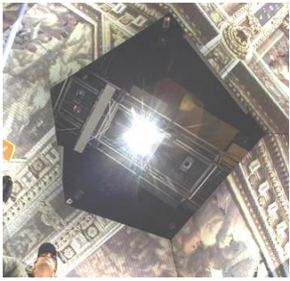
شكل ( 29 ) ، الهيكل الخارجى للكهف المكون من قواطع من الألومنيوم ، الذى يبلغ ارتفاعه اكثر من 5.3 م وعمق أكثر من 7 أمتار، أجهزة الإسقاط ( وحدات البروجيكتور ) ، وعددها 35 وحدة لإنتاج الصورة ثلاثية الأبعاد
