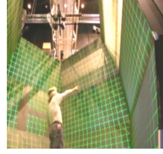
شكل ( 29 ) ، الهيكل الخارجى للكهف المكون من قواطع من الألومنيوم ، الذى يبلغ ارتفاعه اكثر من 5.3 م وعمق أكثر من 7 أمتار، أجهزة الإسقاط ( وحدات البروجيكتور ) ، وعددها 35 وحدة لإنتاج الصورة ثلاثية الأبعاد
