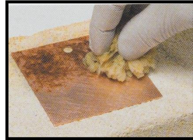
شكل (12) طريقة تطبيق الباتينا باستخدام قطع الأسفنج )
