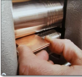
شكل(2) رسم توضيحي لعملية الدرفلة (Jhon Sartin,2013:75)
