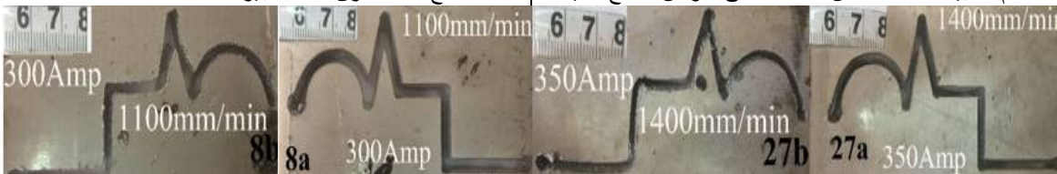
شكل (12) يوضح منظر من الأمام والخلف لعرض مسار القطع للعينات 27، و 8 (أ، ب) عند طاقة 350، 300 أمبير وسرعات قطع 1400، و 1100 مم/د على التوالي.
