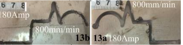
شكل (15b) يوضح منظر من الأمام والخلف لعرض مسار القطع للعينات 13، و 27 (أ، ب) عند طاقة 180 و 350 أمبير وسرعات قطع 800، و 1400م/د على التوالي.
