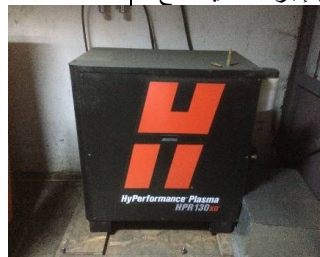
الصورة (8) توضح غرفة توليد البلازما نتيجة خلط الهواء والقوى الكهربائية للماكينة
