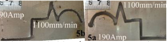
شكل (14) يوضح منظر من الأمام والخلف لعرض مسار القطع للعينات 5، و 8 (أ، ب) عند طاقة 190، و 300 أمبير وسرعة قطع 1100م/د.
