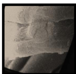
شكل (11) افضل العينات المنتجة تحت البحث وشكل (12) اقل العينات المنتجة تحت البحث بعد المعالجة ويوضح الماسح الإلكتروني مورولوجيا السطح للأقمشة المنتجة تحت البحث حيث يتضح وجود مواد المعالجة علي سطح القماش اي كانت نوعها وذلك كما يتضح في الشكل (11، 12) الخلاصه:
