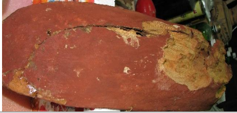
صورة (٢) تبين تفاصيل الشق الكبير (الانفصال) في خلفية المركب الأول بدءا من القاعدة حتى السطح العلوي .
