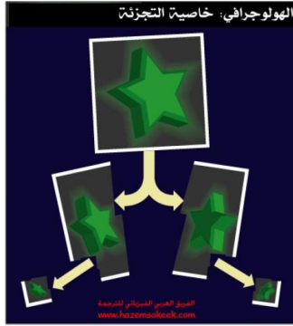
شكل رقم (٦) توضح خاصية التجزئة فى الهولوجرام
