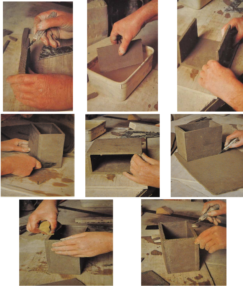
شكل (١٠) يوضح طريقة عمل آنية بطريقة الشرائح، هذا إلى ضرورة خدش طرقي كل قطعة عند لصقتها في الأخرى قبل دهانها بالمحلول الطيني.
