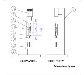
1)Base ;2) Pressing wheel handle ;3)Threading shaft ;4)Lower piston;5)Metallic mold/die;6) Raw material of prequating; 7)Upper piston; 8)Press digital gage; 9)Rear frame.
