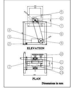
1)The chassis ;2) Electrical motor articulated point ;3) Electrical motor ;4)Gear box ;5)Baffle;6)Feeding gate;7)Driven pulley ;8)Belt ;9)Drive pulley ;10)Support leg;11)bearing;12) Durability box;13)Rivets.
