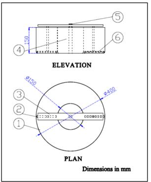
1)Cylindrical pan ; 2)Plan skimmer ; 3)Agitator ; 4)Motor; 5)Motor hexagonal shaft; 6) Notched skimmer.
