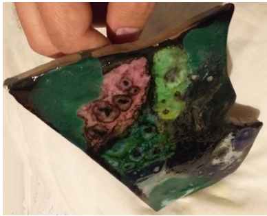
(شكل 3) عينة لصهر الزجاج علي سطح البلاطات الخزفية المجلزة التي شكلها الباحث لأرضية الأعمال .
