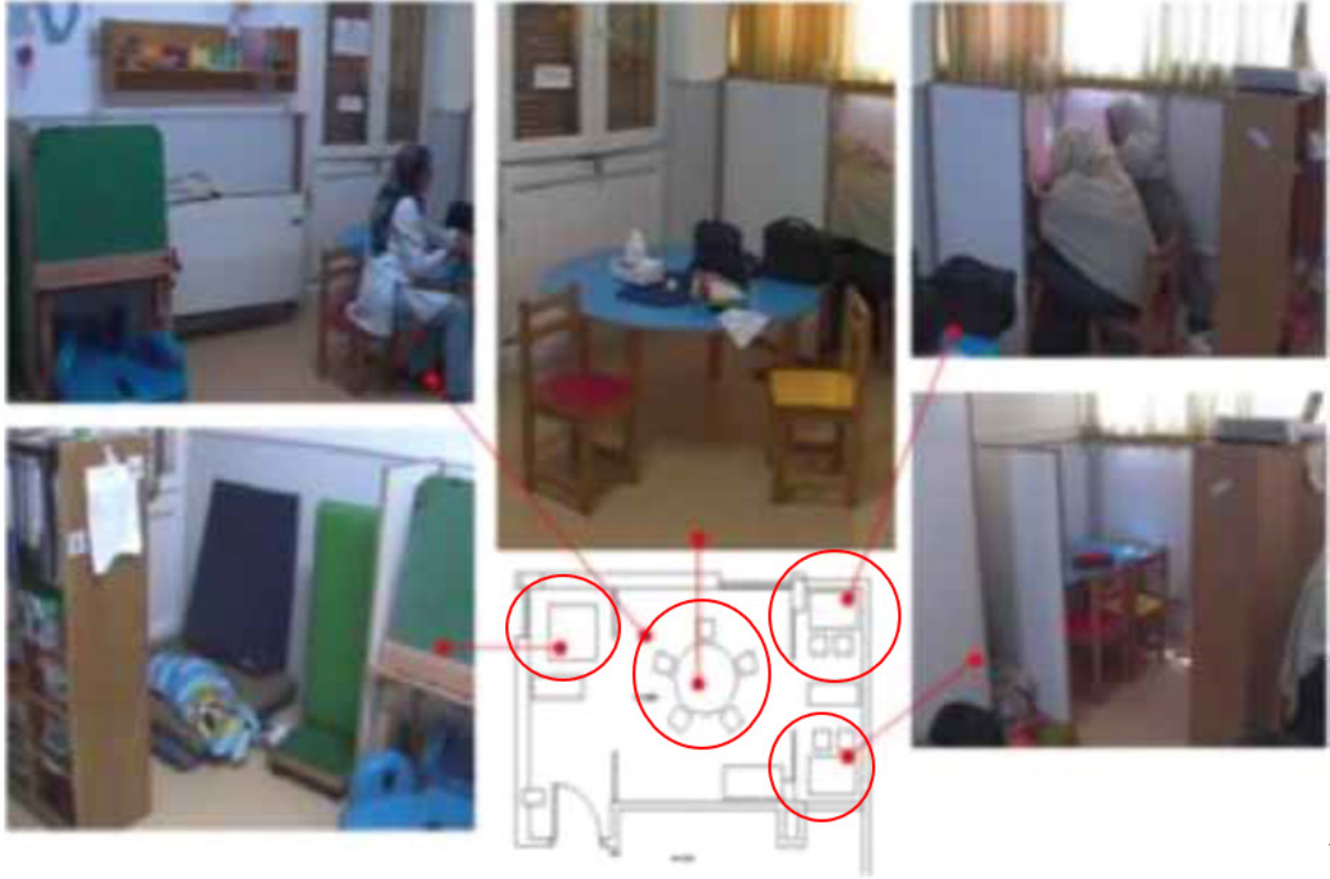
شكل (11): يوضح كيفية تنفيذ دمج مساحة مصطفى مساحات الهروب في الفصل الدراسي؛ بحيث توضح المناطق المحددة بالدائرة الحمراء في المسقط الأفقي أماكن مساحات الهروب (21).
