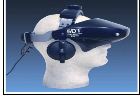
شكل (٢) جهاز عرض مثبت على الرأس فوق المنظر الذي يراه المستخدم
