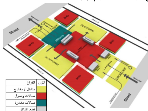
شكل رقم ١- العلاقات الوظيفية بين الفراغات المختلفة لمحطات سكك حديد الهند المصدر : Manual for standards and specifications for railway stations, Ministry of Railways Government of India, June 2009
