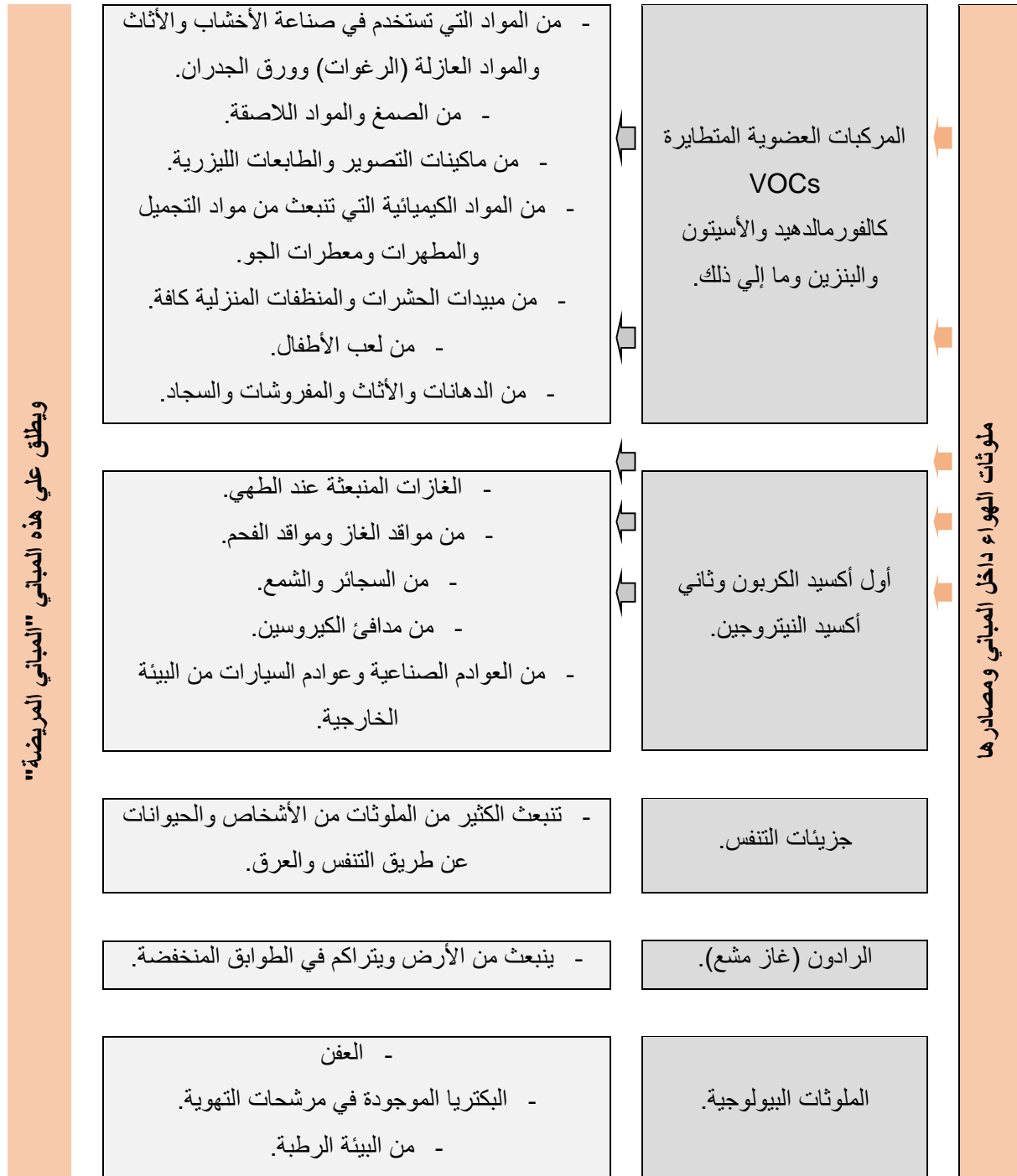
شكل ١: مخطط يوضح ملوثات الهواء داخل المباني ومصادرها. (الباحثة عن [16])
