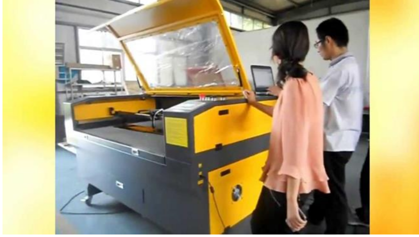
شكل رقم (٧) مكيئة الليزر للنقش على المعادن
