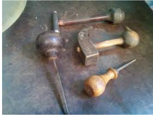
شكل رقم (٥) أدوات النقش اليدوي على النحاس
