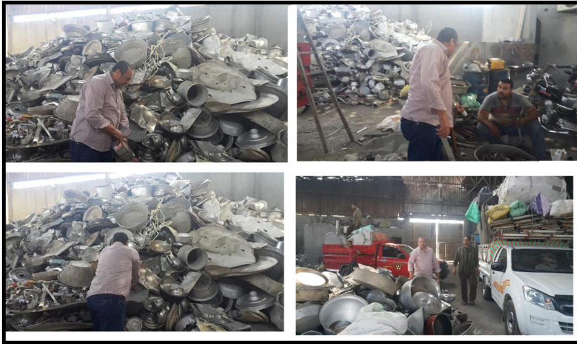
صور (١-٢-٣-٤) توضح مراحل تجميع وإعادة فرز مخلفات الألمنيوم (الألمنيوم المستعمل) بمركز ميت غمر.
