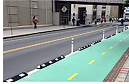
شكل (٧) أشكال أحواض الزراعة كوحدات منفردة لحماية ممر الدراجات (يسار) وصدادات السيارات المطاطية لتحديد ممرات الدراجات
