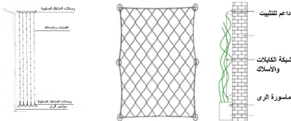
شكل رقم ٣- نظام شبكات الكابلات والأسلاك (يمين) - طريقة تثبيت الكابلات والأسلاك باستخدام المشابك الصليبية (يساراً) (المصدر: http://www.intechopen.com , 2015)
