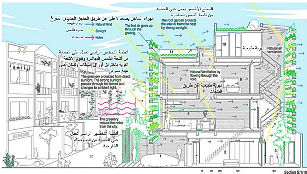
شكلا رقم ٨- توضيح دور الواجهات الخضراء في التهوية والحفاظ على الطاقة في منزل Stacking Green - المصدر: (www.dezeen.com, 2016)
