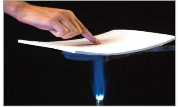
شكل (٢) المقطرة الخارقة لهلاميات الهواء في منع انتقال حرارة شعلة ملتهبة{٢٣}.
