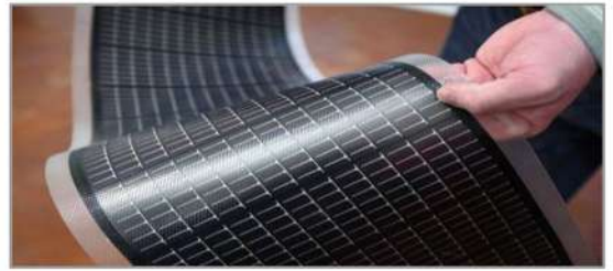
شكل (١٩) مرونة خلايا لأغشية الرقيقة النانوية الشمسية {٢٤}.
