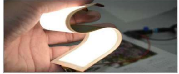
شكل (١٦) مرونة و رقة سماكة الصمامات الثنائية العضوية الباعثة للضوء {٢٦}.
