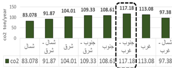
شكل رقم ٣ - الحالة الأولى: يوضح نتائج المحاكاه لانبعاثات غاز ثاني أكسيد الكربون لنموذج فصول مدرسية بإختلاف التوجيه بالمقارنة مع حالة الأساس زجاج شفاف مفرد 3مم (SHGC=0.681) (LT= 0.898) (UV= 5.894)
