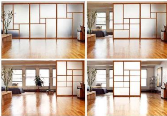
شكل ١ الفواضع المتحركة المطوية والمنزلة لتقسيم الحيز الداخلي بشكل مرن
