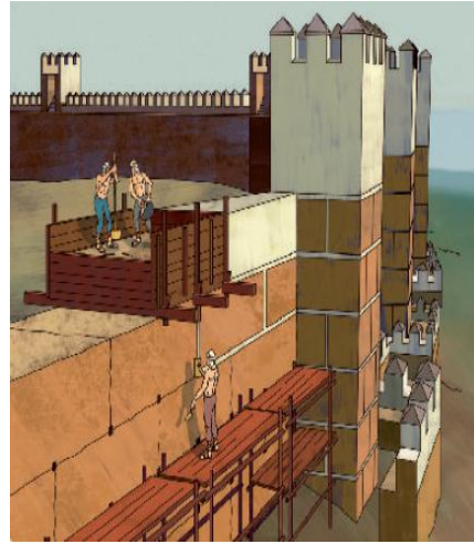
شكل (7): يوضح كيفية البناء بالطابية. عن: La Asignatura Badajoz , p.14.
