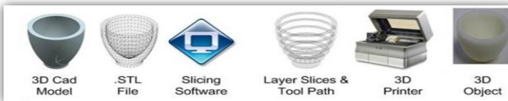
شكل (1) : يوضح مراحل عمل المجسم ثلاثي الأبعاد
