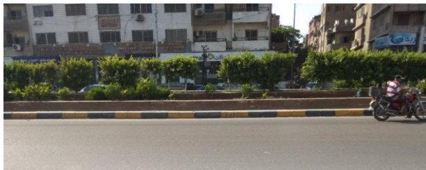
شكل (23) صورة توضح السور الشجري لمنع عبور المشاة السطحي والذي تم عمل فتحات به لعبور المشاة - المصدر الباحث
