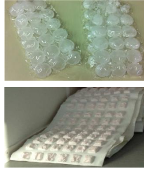
شكل رقم (11): يوضح شكل اقراص pcm واستخداماتها في امتصاص الحرارة المصدر: www.google.com/eg/search?q=phase+change+materials(PCM)&rlz
