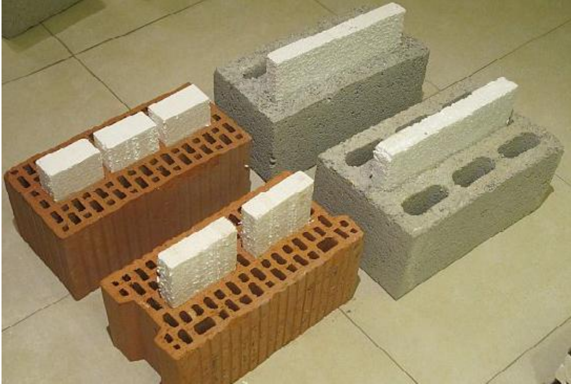
الشكل 3: نماذج من العزل الحراري للجدران الخارجية بنظام البلوك الأسمنتي والفخاري الأحمر المعزول البوليسترين [24].
