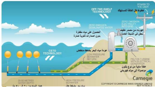
شكل (12) توليد الكهرباء بطريقة الأجهزة ذات الرأس الطافي المصدر: م أسامة الفضل - طاقة الأمواج - الانترنت
