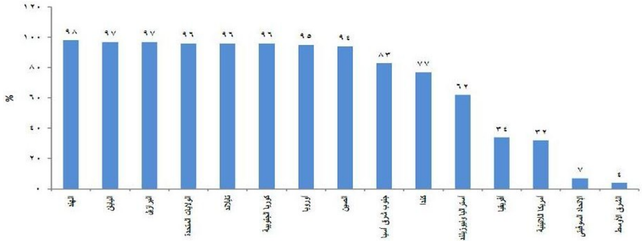
شكل ٣-٥- الأهمية النسبية لإجمالي مشاركة الفحم وفحم الكوك البترولي والكتلة الحيوية في إنتاج الأسمنت على مستوى دول العالم عام ٢٠٠٦
