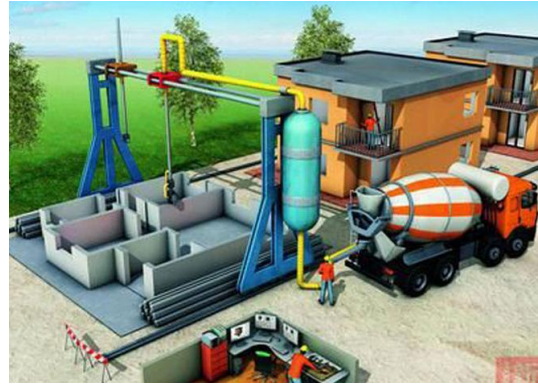
شكل (1) - نظام عمل آلة التشييد الرقمي الكنتوري ونظام حركة المجرفة.
