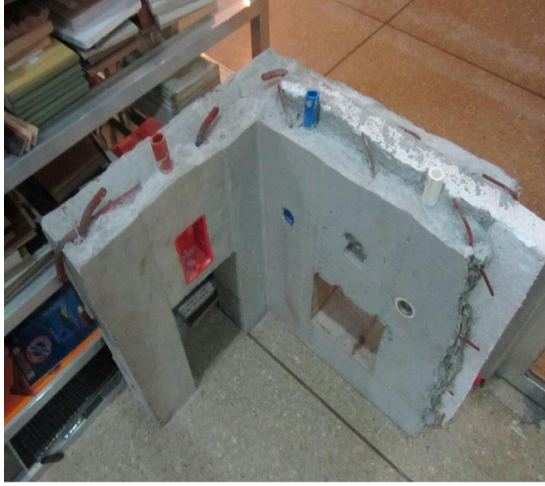
شكل (5) – عملية تجميع وحدات العناصر الكهربائية من خلال تقنية التشييد الرقمي الكنتوري.
