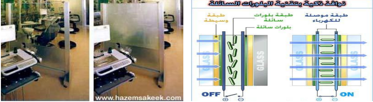
شكل (14) النوافذ الذكية بتقنية البلورات السائلة والتحول من اللوح الشفاف للمعتم www.hazemsakeek.com
