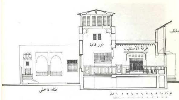
شكل ( 22 ) قطاع توضيحي لكيفية استخدام الشخشيخة مع العناصر المعمارية الأخرى المصدر: عباس الزعفراني، العمارة الشمسية السالبة في المناطق الحارة، رسالة ماجستير، ١٩٩٤م
