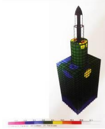
صورة رقم 5 النمذجة الرياضية لمآذنة جامع أحمد بن طولون بالقاهرة، مصر المصدر: القاهرة التاريخية
