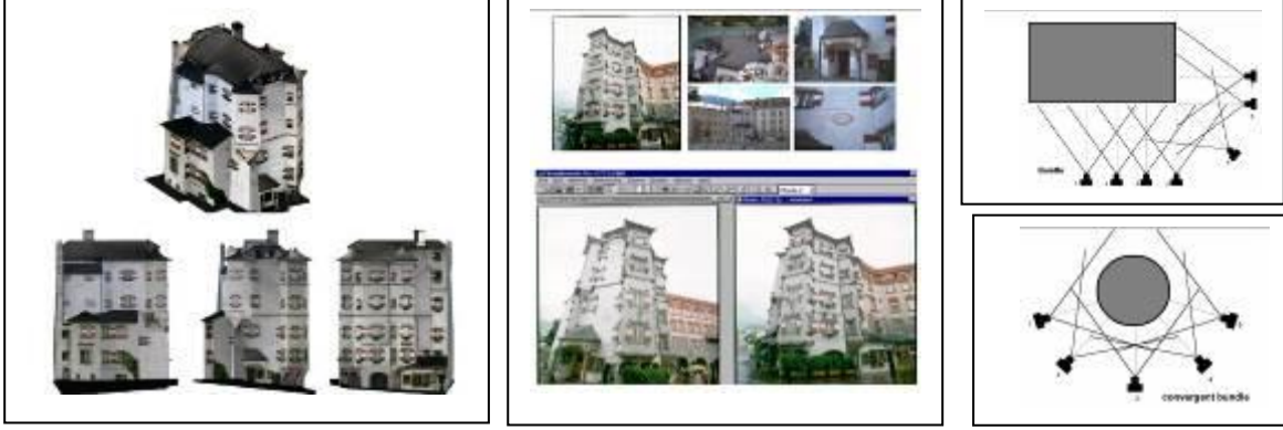
صورة رقم 18: 30 التصوير بحزمة الكاميرات و مخرجات نظام الفوتوجراممري المصدر : Architectural photogrammetry, basic theory, procedures, tools
