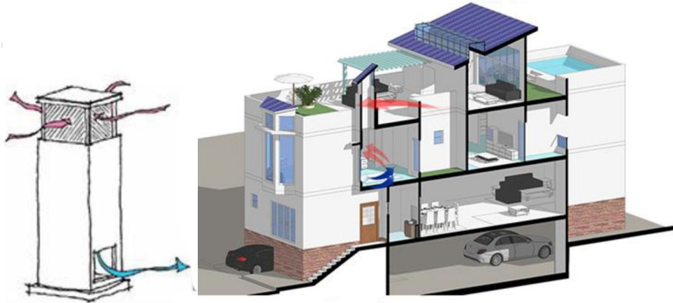
شكل رقم 21 ، 22 توجيه حركة الهواء داخل المبنى عبر اختيار أماكن الفتحات المصدر: الباحث
