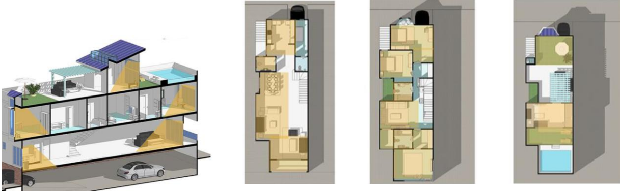
شكل رقم 9،10،11 ، 12 تصميم المبني بحيث أن يستقبل أكبر كمية من الإضاءة الطبيعية المصدر: الباحث
