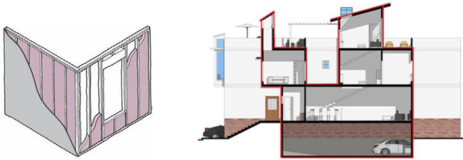
شكل رقم 2، 3، التحكم في الغلاف الخارجي للمبني وعزله ضد الحرارة لخفض استخدام طاقة التبريد
