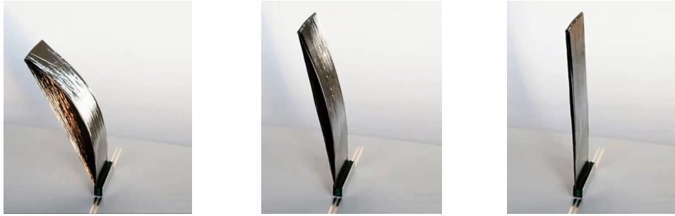
يوضح الشكل رقم (3) طريقة الانحناء نتيجة لتعرض لطاقة حرارية (4)
