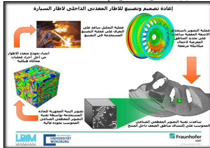
شكل(8) الحصول على العديد من المعلومات والبيانات المساعدة على اعادة تصنيع احدى الاطارات المعدنية الداخلية باستخدام تقنية التصوير المقطعي الصناعي المحوسب(iCT)
