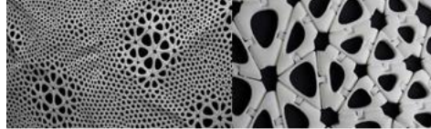
شكل (10) يوضح مجموعة من الأقمشة مطبوعة ثلاثية الأبعاد بطريقة chainmail أي وحدات متماثلة تتجمع معاً بحلقات (41)
