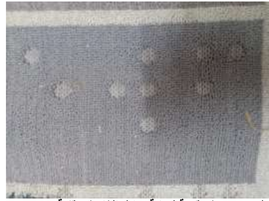
شكل 13 صورة مقربة لكتابة برايل الغائرة بتقنية loop and flat
