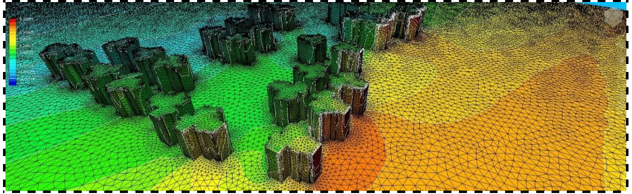
شكل 16. أحد خطوات عملية المحاكاة ، والنتائج الموضح هي الضغط الاستاتيكي على حوائط المباني (الباحث)
