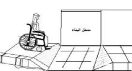
شكل (٩) مثال للتغير المفاجئ في الميل العرضي للرصيف [37]
